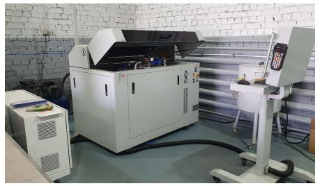
Для этой услуги мы используем современный автоматизированный комплекс гидроабразивной резки «IRON MAC – WATERJET 420S»
